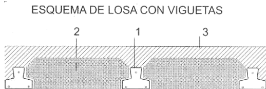
Fig. 4.3(a) Componentes de losas prefabricadas alivianadas.
