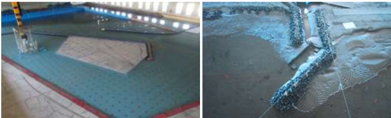
Figura 7. Modelo hidráulico con fondo fijo y fondo móvil (IMT, 2020)
