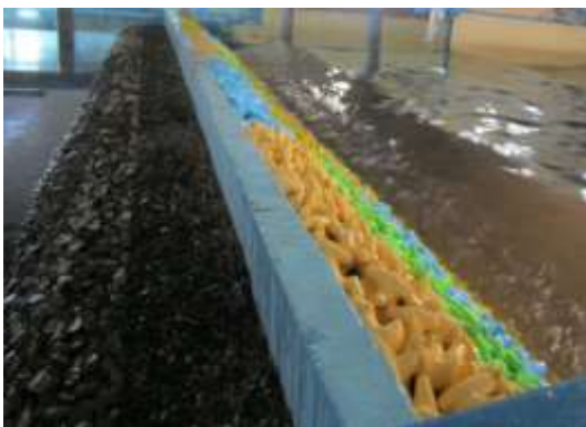
Figura 8. Resultados de un ensayo de Estabilidad y el gráfico de daños que se obtiene del análisis de la estructura (IMT, 2020)
