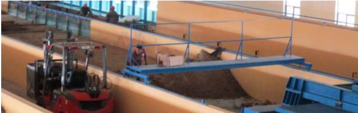
Figura 3. Vertimiento de la arena al interior de un canal de olas. (IMT, 2020)
