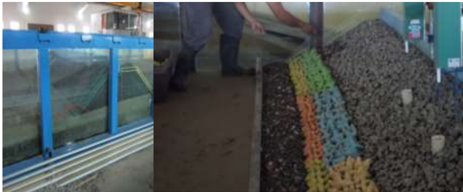
Figura 6. Colocación de materiales de las capas de núcleo, capa secundaria y coraza.
