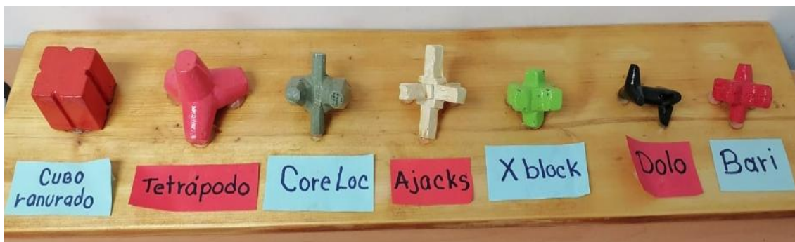
Figura 8. Prototipo a escala de elementos de concreto usados para protección en rompeolas.
