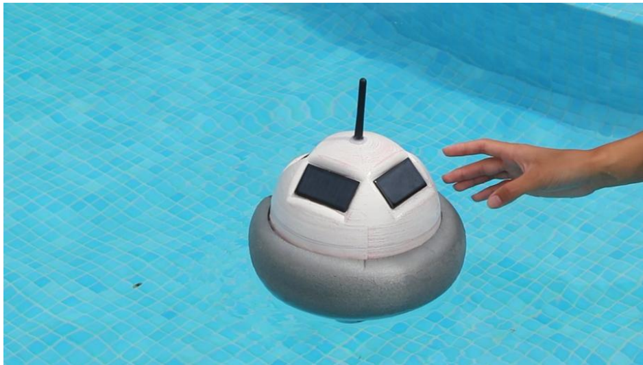
Figura 12. Prototipo de boya medidora de oleaje impresa en 3D.
