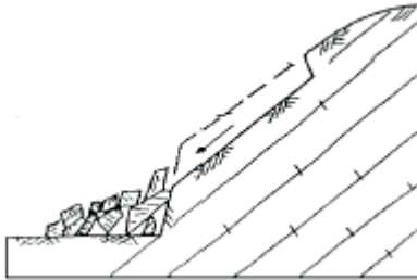
Deslizamiento planar en macizo rocoso
