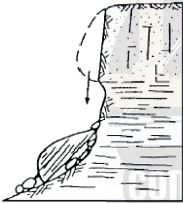
Figura 3.1 Desprendimiento de bloques
