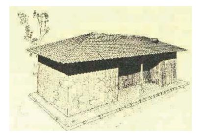
Este método consiste en apisonar capa por capa en medio de tablones con el espesor normal de los muros de piedra, tierra preparada con este propósito, apisonada de esta manera, la tierra se liga, toma consistencia y forma una masa homogénea que puede ser elevada hasta una altura necesaria para una casa.
