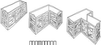
**PANELES.** Se necesitan 3 o 4 tablas de madera seca, indeformable y liviana, cepilladas para obtener un paramento liso y evitar que la tierra se adhiera a las formaleta, éstas se ensamblan y unen mediante largueros y barras.
